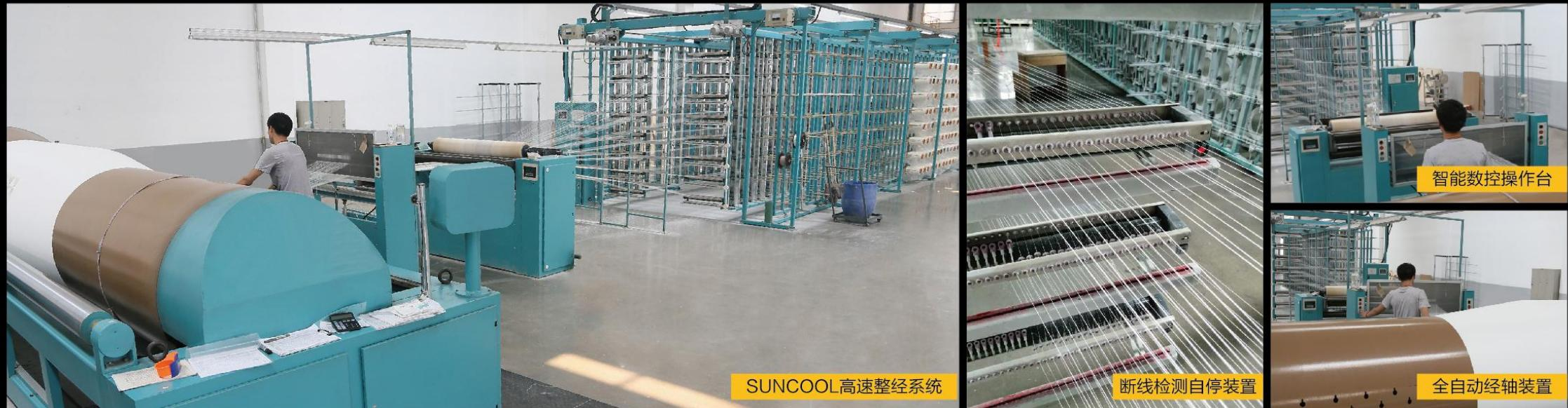
SUNCOOL拥有大型高速整径生产线多条，整经密度均匀，整经线根数、长度、色经排列循环均超过织造工艺标准，整经排列均匀，张力稳定，生产效率高，进口设备及严苛的工艺要求保证森酷面料质量稳定。
